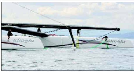
HORS NORMES. La nouvelle bête de course d'Alinghi mesure 37,50 m de long. Son mât est haut de 50 m. Il a fallu 100 000 heures pour concevoir et construire ce catamaran. (KEYSTONE)
